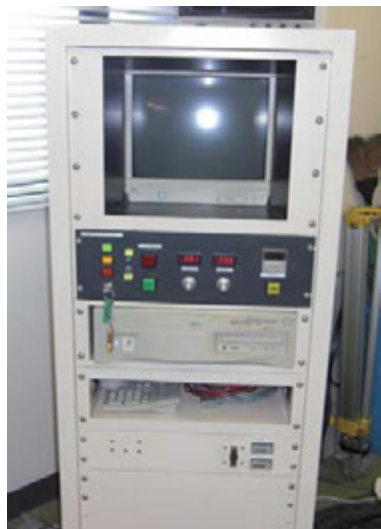
軟X線発生装置 (DCTS-7003 ; SOFTEX社)
