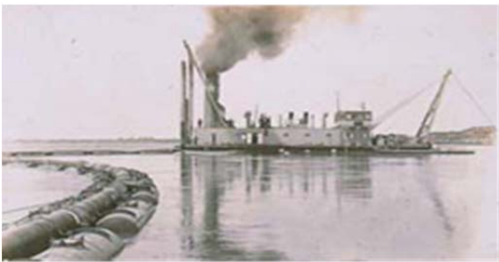
▲浚渫船「昭和号」（昭和2年配置・ポンプ船・浚渫能力300m 3 /h） 挖砂船「昭和號」（昭和2年配置・幫浦船・挖砂能力300m 3 /h）
